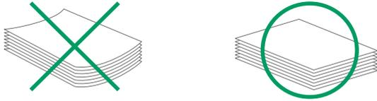
用紙のソリや変形を手で修正してから印字させる、
